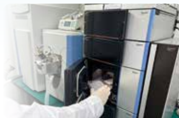
超高分辨 Orbitrap 质谱仪
